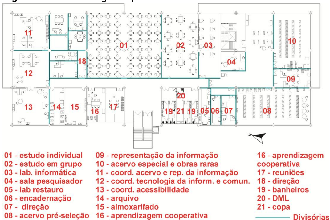
Figura 4. Planta do segundo pavimento
